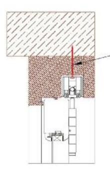
MINIMUM 8mm DIAMETER MINIMUM 100mm LONG WOOD SCREW
